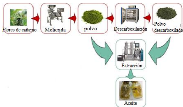
Figura 4. Secuencia de procesos para la extracción de aceite de cannabis.
