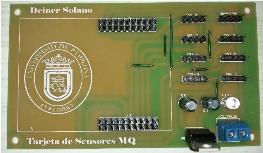
Figura 46. Circuito electrónico de la nariz electrónica en vista real
