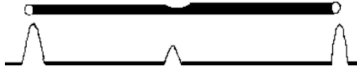
Figura 6. Detección del daño en la tubería por variación de la impedancia.
