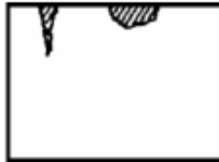
Figura 3. Corrosión por picadura en superficies metálicas.
