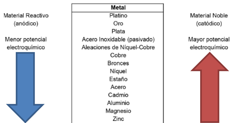
Figura 2. Arreglo de metales y aleaciones más empleadas en una serie galvánica.
