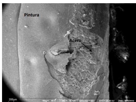
Figura 11. Superficie anticorrosiva después de 10 días de incubación en el bio-reactor (zoom: x48)
