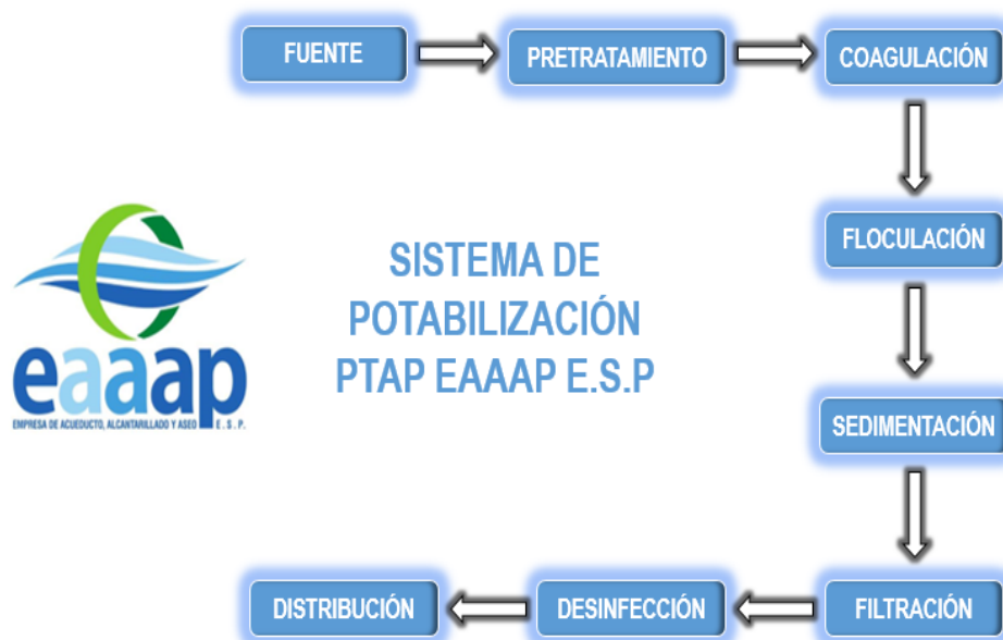
Figura 7. Diagrama de flujo sistema de potabilización PTAP EAAAP E.S.P.
