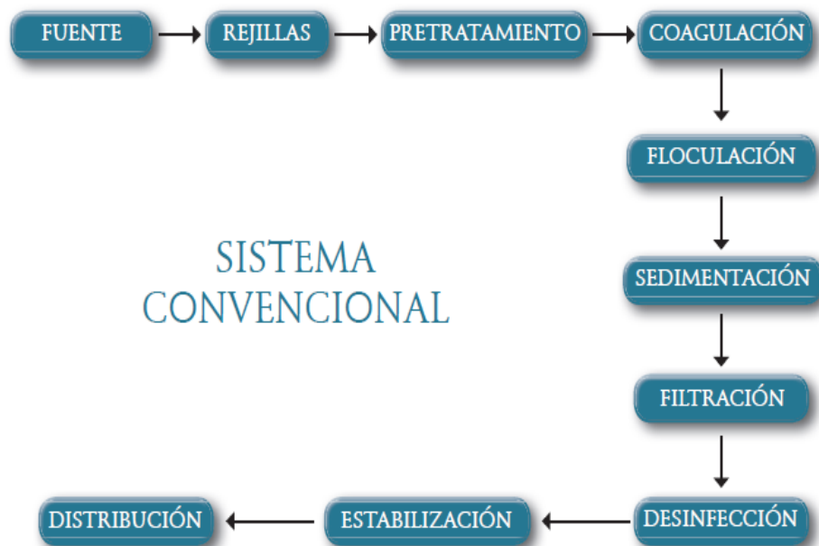
Figura 2. Sistema de potabilización convencional.
