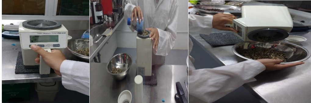
Imagen 32. Medición de la humedad. Fuente: Autor
