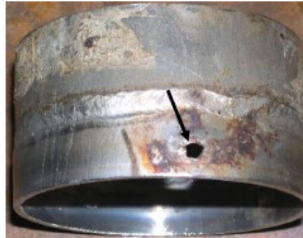
Figura 9. Hueco generado por corrosión localizada en una tubería.
