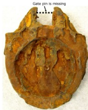
Figura 8. Efectos de la corrosión uniforme en una compuerta.
