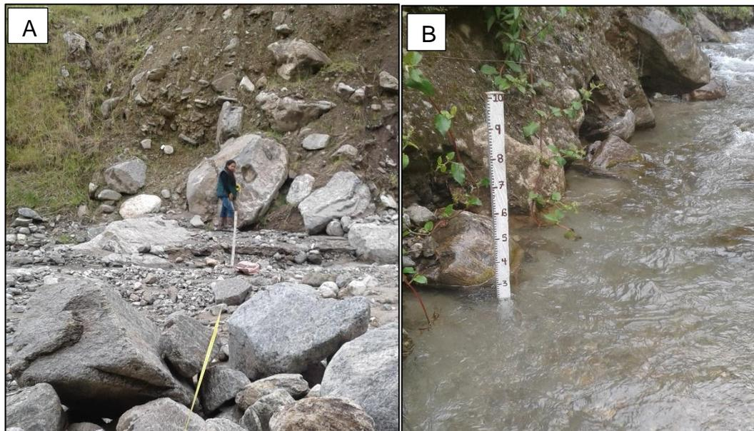
**Figura 13.** Medición de niveles y secciones, A- sección punto 3 lugar Cascaral, B- Mira 1 lugar La Esperanza.
