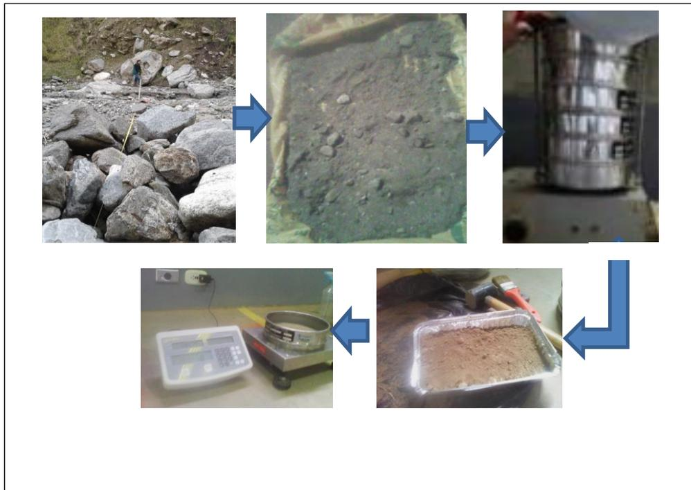
**Figura 5.** Proceso análisis granulométrico de los sedimentos de la quebrada Hato Viejo
