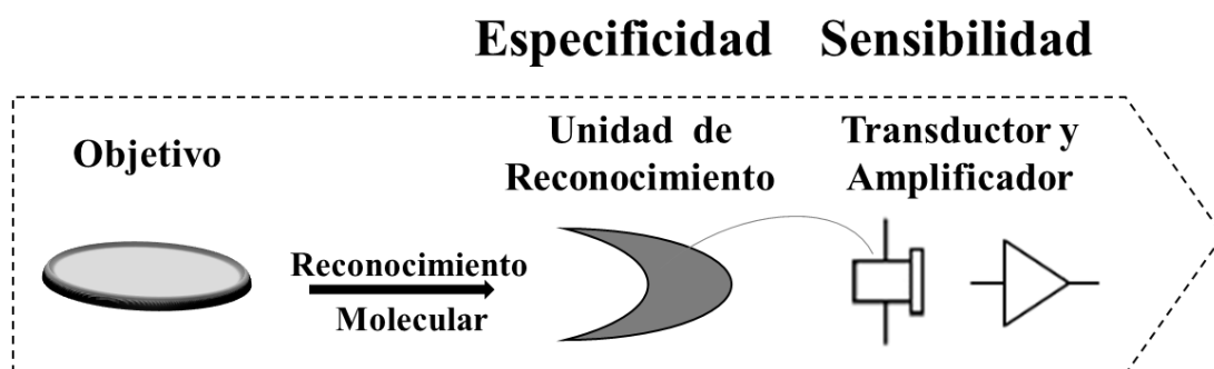
Figura 2. Secuencia del reconocimiento y conversión de señal de un biosensor. Fuente: (D. Liu et al., 2020). Trends in miniaturized biosensors for point-of-care testing [Figura 1]. Recuperado de https://www.sciencedirect.com
