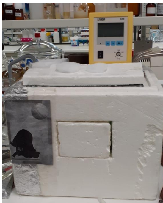
Figura 2. 5. Baño de etanol usado para la determinación visual de las transiciones líquido-sólido.
