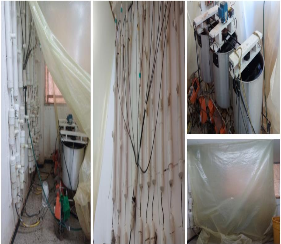
Ilustración 9. Montaje del sistema, filtro anaerobio de flujo ascendente-sistema de alimentación del sustrato
