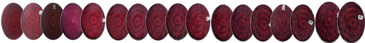
En el diagrama 5 se muestra el cambio de color durante el proceso de secado a temperatura 40°C. Flujo de aire (a). 3,95 m<sup>3</sup>/h, (b). 4,95m<sup>3</sup>/h, (c). 5,95m<sup>3</sup>/h respectivamente
