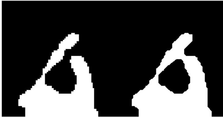
**Figura 3.5.2.4** Aplicación de elemento estructurante de disco en una imagen utilizando filtro de clausura.
