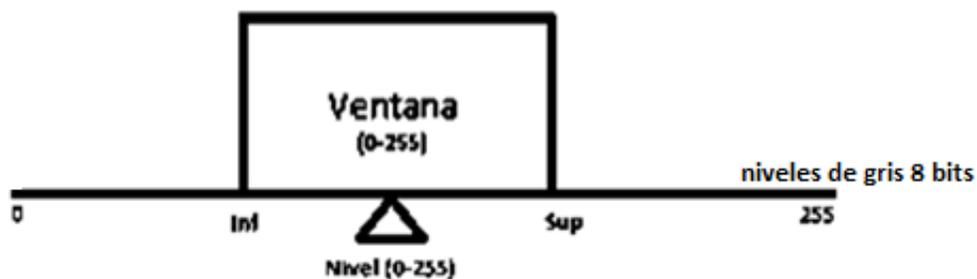
Figura 4.2.1.1 Esquema de realce Ventana y Nivel.
