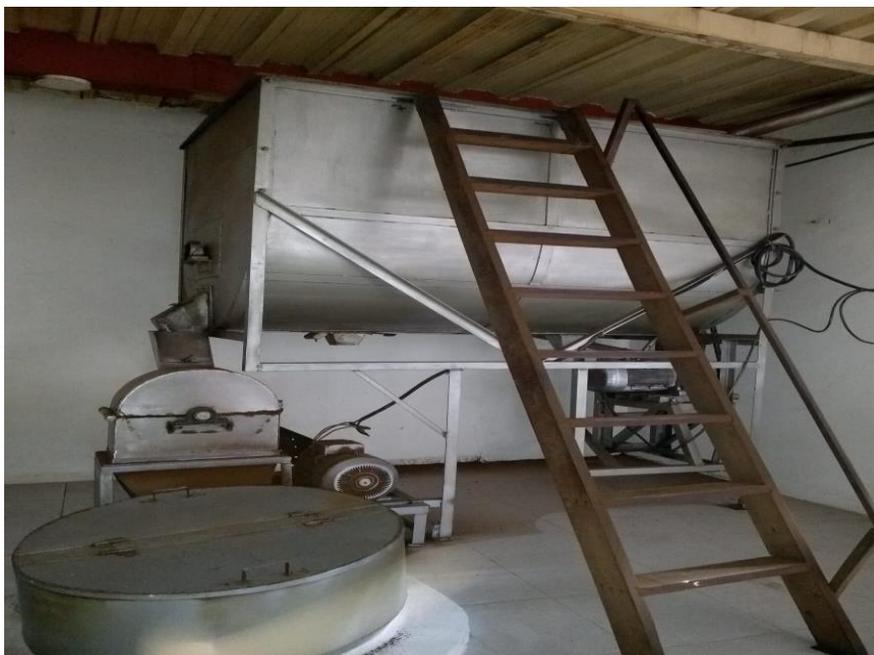
Figura 11 Molino de martillo centrífugo, actualmente en uso.
