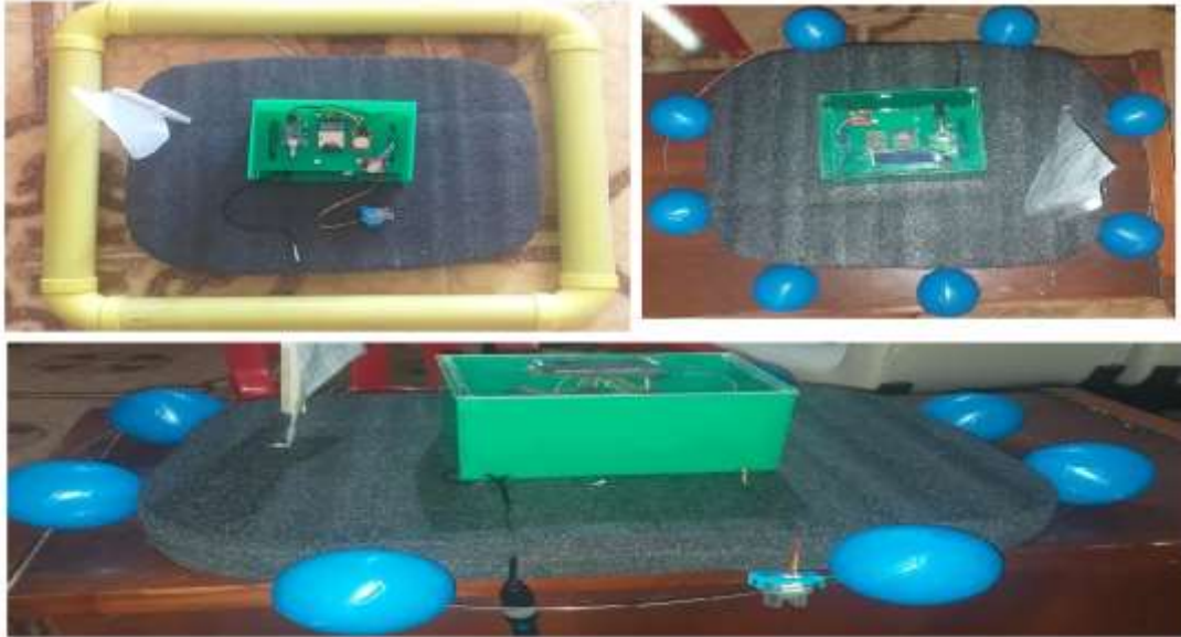
Figura 42. Encapsulamiento de la etapa funcional y mecanismo flotante del sistema de monitoreo y seguimiento de variables para la calidad del agua en cultivos de peces. (Elaboración propia)
