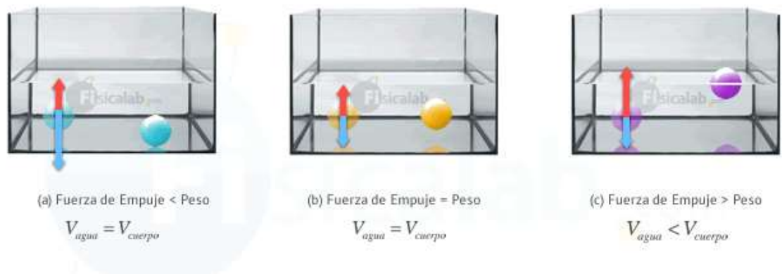
Figura 10. Sometimiento de un cuerpo a un fluido con fuerza de empuje, menor(a), igual (b) o mayor (c) a la de dicho fluido (20)
