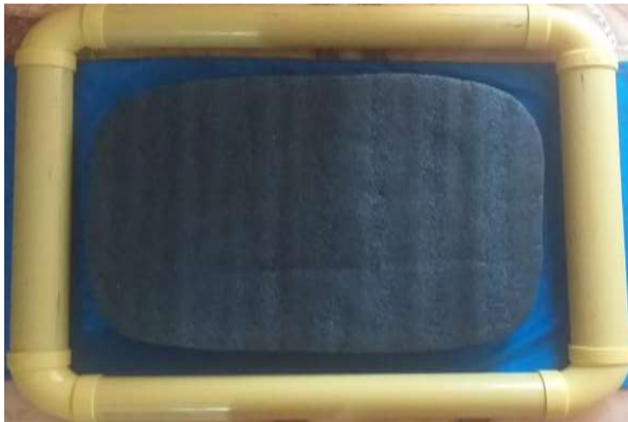
Figura 40. Sistema de flotación con tubería PVC y espuma, donde se ensambla la etapa funcional del sistema. (Elaboración propia)
