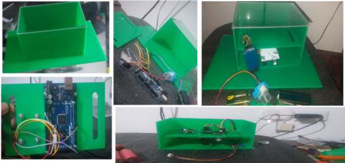
Figura 41. Encapsulamiento de las etapa funcional del sistema de monitoreo y seguimiento de variables para la calidad del agua en cultivos de peces. (Elaboración propia)
