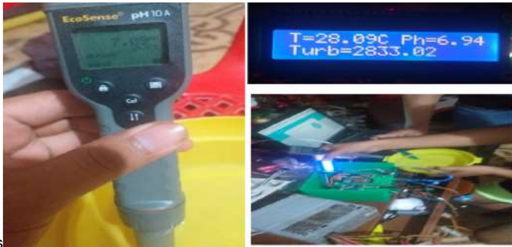
Figura 43. Calibración del sensor de PH. (Elaboración propia)
