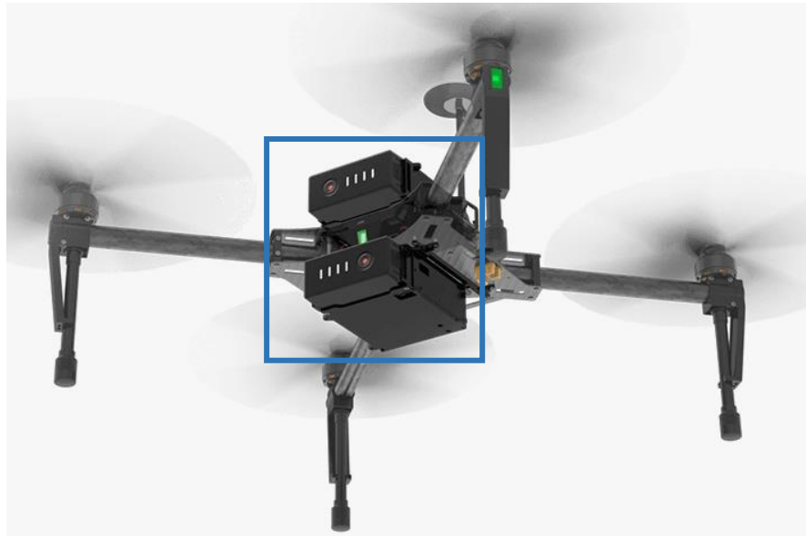
Figura 10 Compartimientos doble de batería. Fuente: https://www.dji.com/matrice100/features#sub-feature
