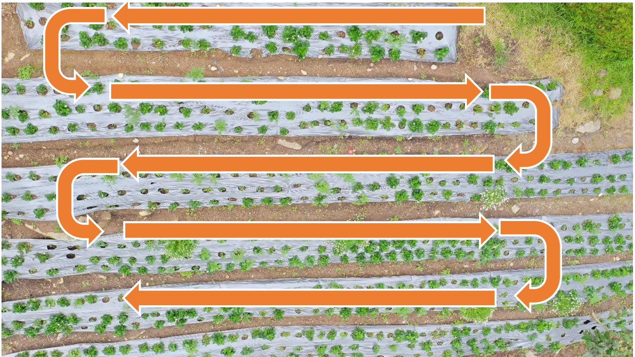
Figura 38 Trayectoria de vuelo en forma de cuadrícula. Fuente: Autor
