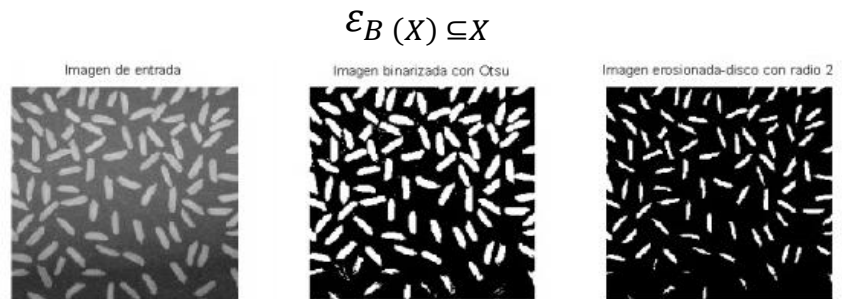
Figura 20 Imagen original, imagen binarizada e imagen erosionada de radio 2. Fuente: [22]
