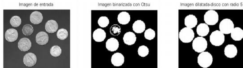
Figura 21 Imagen de entrada, imagen binarizada e imagen dilatada. Fuente: [22]
