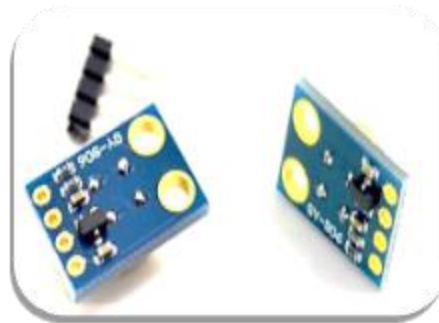
Fig. 3. Circuito MLX90616 vista de posterior.
