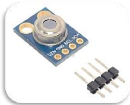
Fig. 2. Circuito MLX90616 vista de frontal.
