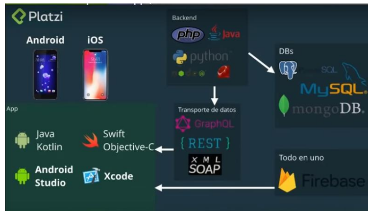
Fig. 38. Ruta de construcción de aplicaciones móviles.
