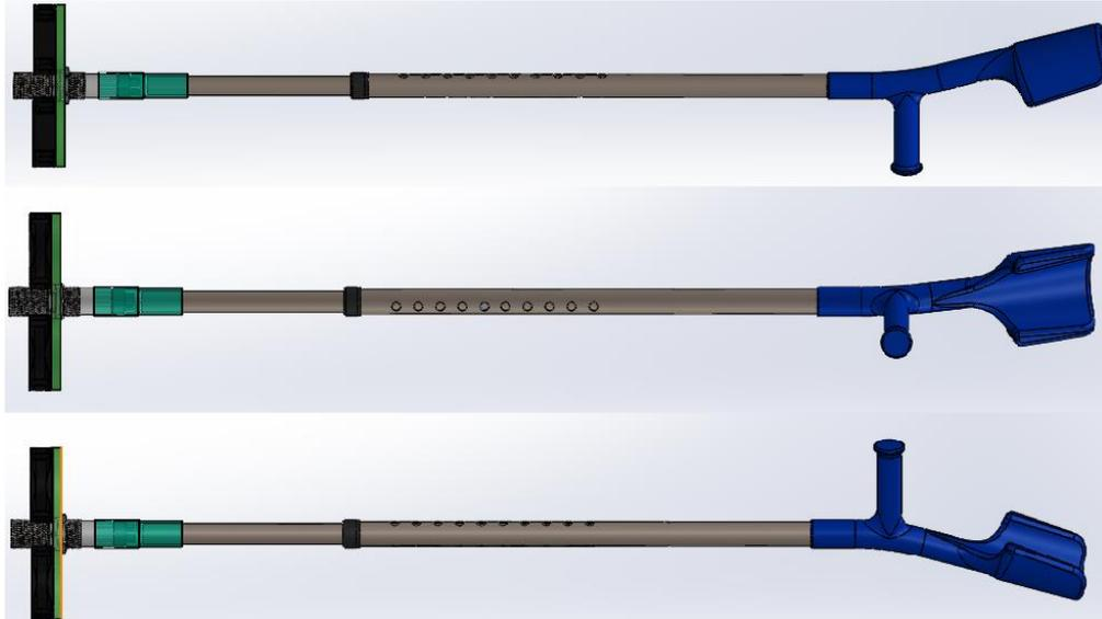
Figura 1. 26. Bastón de codera integral visto desde tres perfiles con el acople del sonar y el banco de coolers [Autor].
