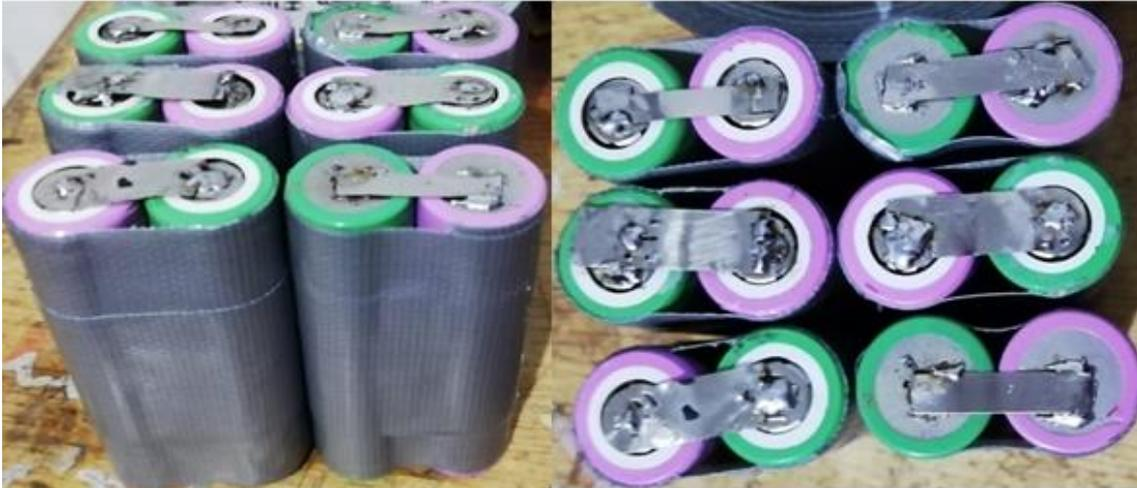
Figura 1. 39. Esquema de conexión de las celdas [Autor].
