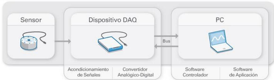
Figura 9. Diagrama en bloques del sistema de adquisición de señales EMG. [17]
