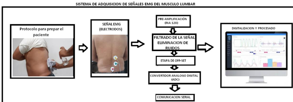
Figura 30. Sistema de adquisición de señales EMG. (elaboración propia)
