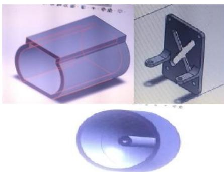
Figura 21. Anemómetro, diseño de sus partes en 3D.
