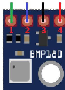
Figura 8. Distribución de pines del sensor BMP180. Fuente.[9]
