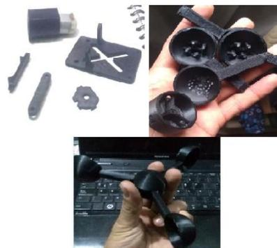
Figura 22. Anemómetro, impresión de partes
