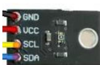
Figura 24. Distribución de pines del sensor VEML-6075.
