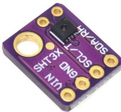
Imagen 2 – Sensor SHT30 de Sensirion en Baquela. [Fuente: MACTRONICA].
