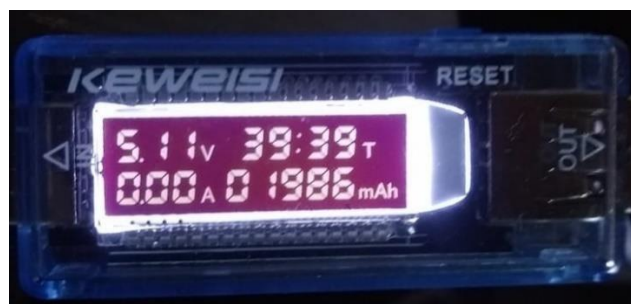
Imagen 36 – Consumo del Arduino con MicroSD y Sensores. [Fuente: Autor].
