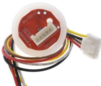
Imagen 4 – Sensor BH1750FVI de ROHM Semiconductor en coraza protectora. [Fuente: MACTRONICA].
