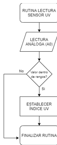
Ilustración 6 – Diagrama de Flujo para el sensor UVM-30A. [Fuente: Autor].
