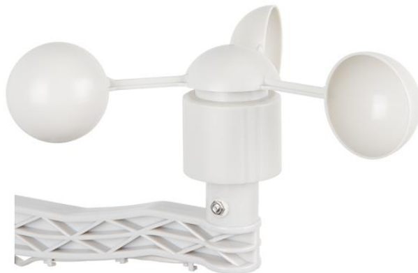
Imagen 7 – Anemómetro para medir la velocidad del viento. [Fuente: SparkFun].
