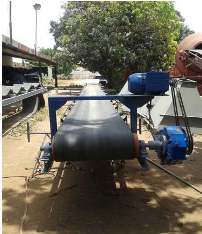
Imagen 15. Banda transportadora y tolva fabric bloq.
