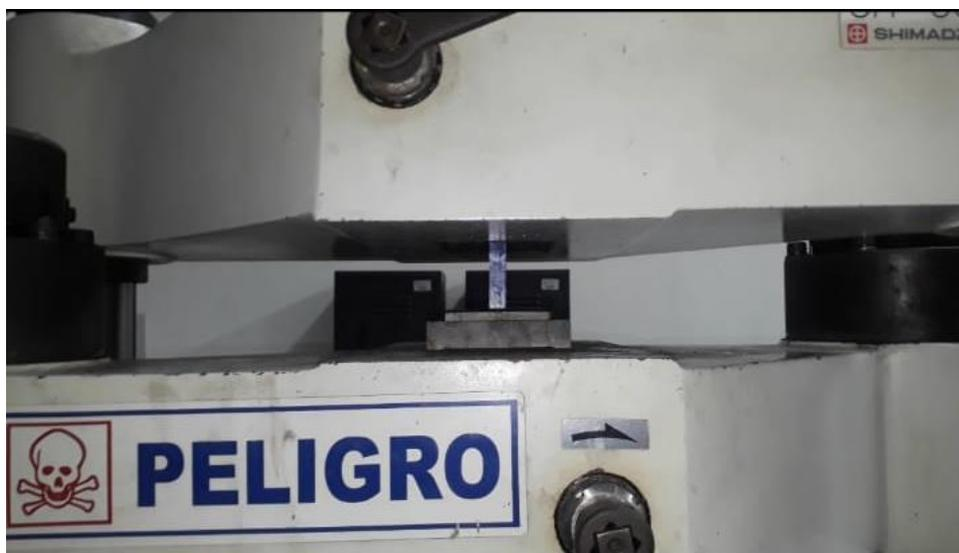
*Ilustración 40 maquina universal lista para realizar el ensayo.*
