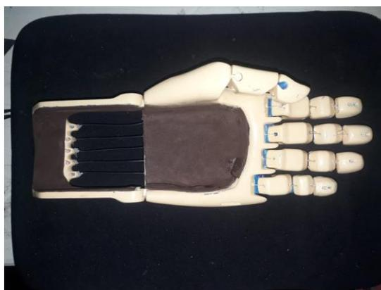
*Ilustración 44 modelo de prótesis*
