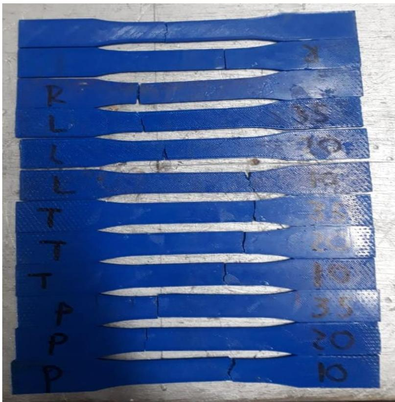
*Ilustración 41 probetas después de la prueba de tracción.*
