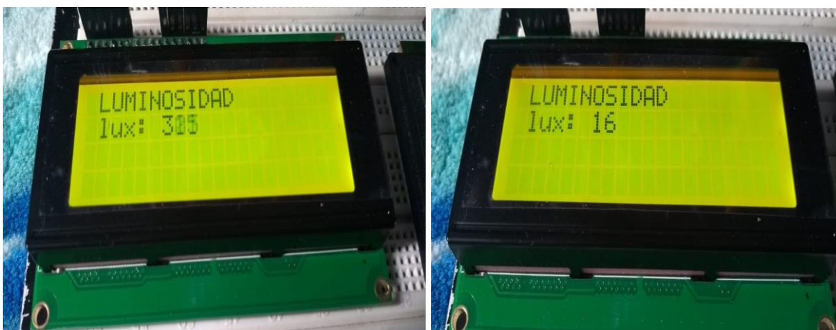
Ilustración 47. Visualización Intensidad Luminosa en el FBR. Fuente: [El Autor]
