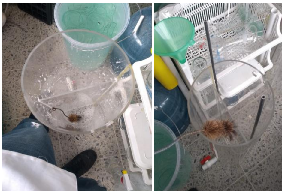
Ilustración 61. Esterilización fotobiorreactores con agua destilada caliente e hipoclorito. Fuente: [El Autor]
