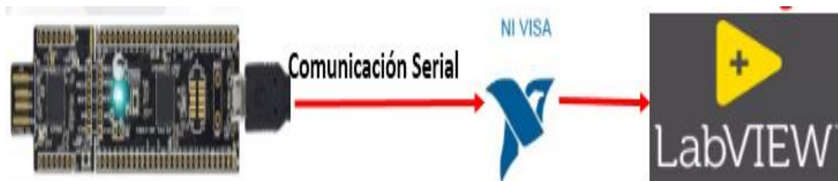
Ilustración 34. Secuencia adquisición y monitoreo de las variables. Fuente: [INSTRUMENTS,2017]
