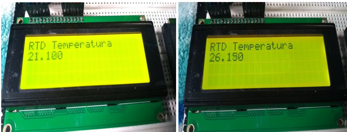
Ilustración 44. Visualización temperatura con PT100. Fuente: [El Autor]
