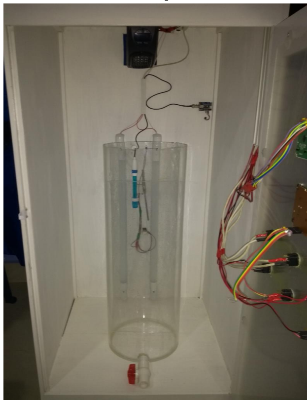
Ilustración 82. Fotobiorreactor Automatizado para pruebas experimento 2. Fuente: [El Autor]
