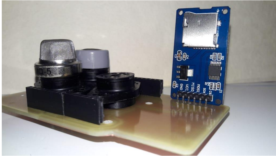
figura 10. Representación de la board de la parte física de la matriz de sensores con sus respectivos componentes. Fuente propia
