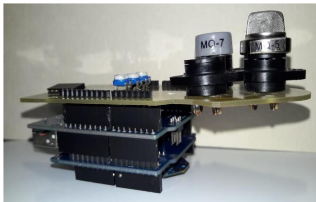
figura 26. Modulo electrónico mutisensorial finalizado. Fuente propia
