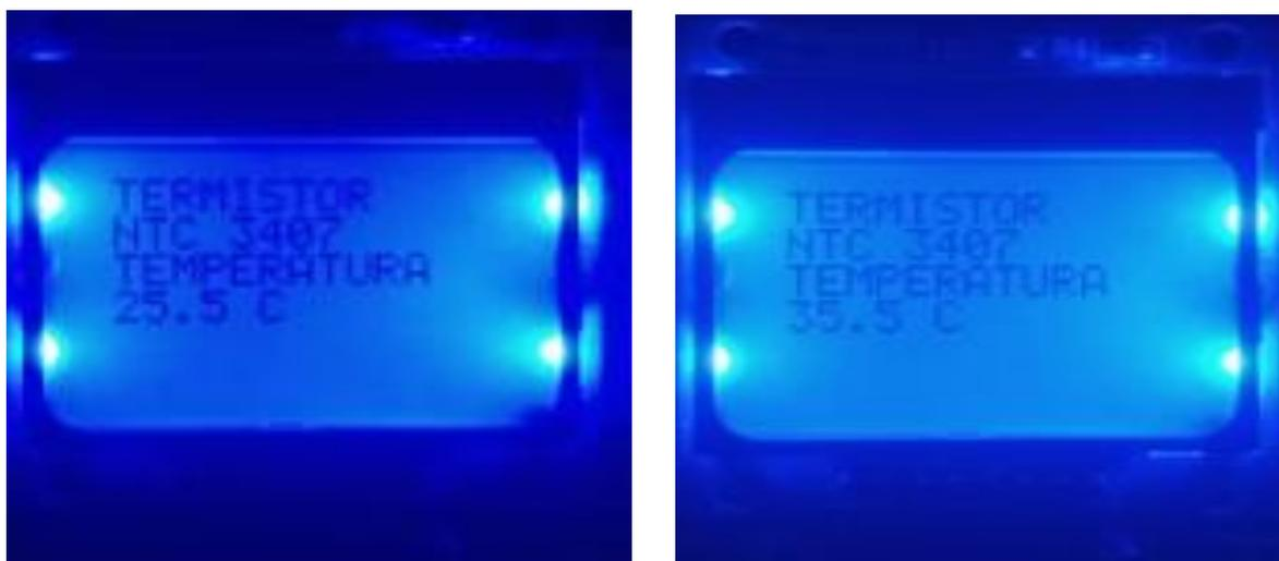
*Ilustración 45 Visualización de temperatura NTC 3704 10K b (fuente: auto)*
