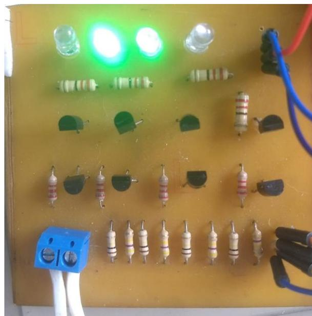
Ilustración 50 Visualización de nivel alto tanque de refrigeración (fuente: auto)
