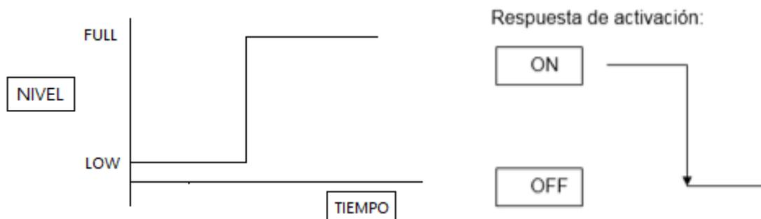
Ilustración 25 Respuesta del sistema activación on/off
