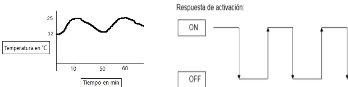
Ilustración 23 Respuesta del sistema y activación On/Off
