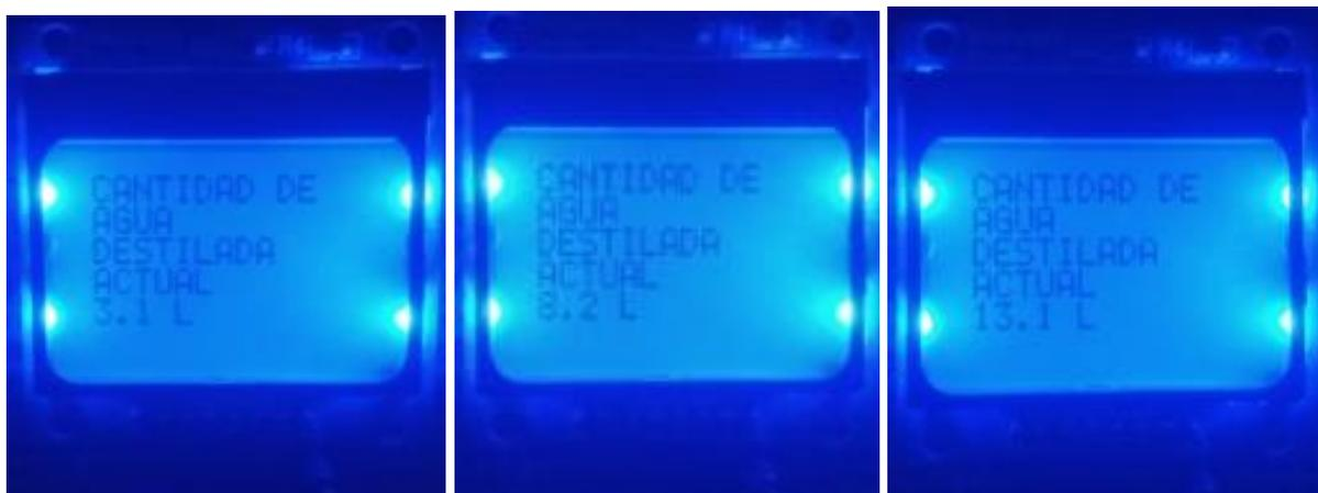
*Ilustración 48 Medición de nivel continuo hc sr04(fuente: auto)*
