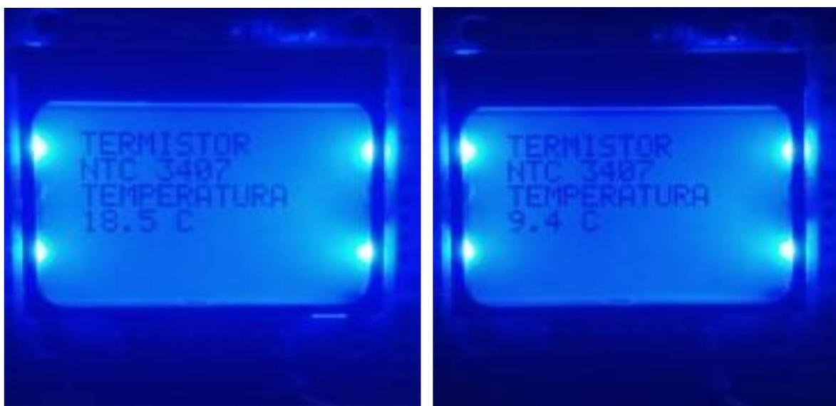
*Ilustración 44 Visualización temperatura NTC 3704 10K a (fuente: auto)*
