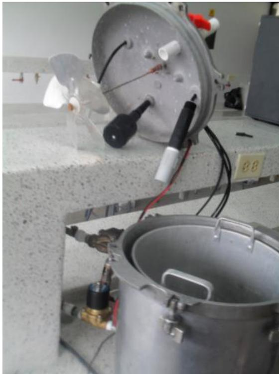
Figura 12. Biodigestor tipo discontinuo, fuente Autor.
