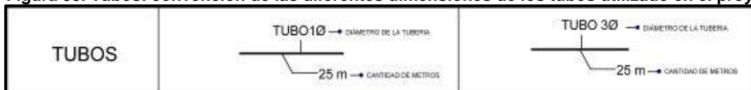
Figura 33. Tubos: convención de las diferentes dimensiones de los tubos utilizado en el proyecto.
