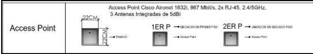
Figura 34. Access Point: punto de acceso inalámbricos utilizados en el proyecto
