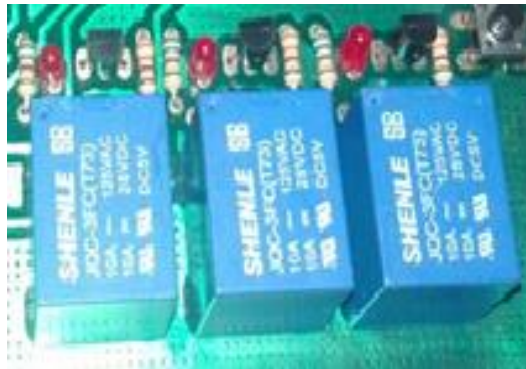
Fig. 43. Circuitos de conmutación o cambio de estado.
