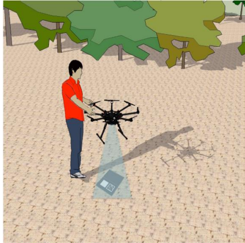
Ilustración 23. Calibración de los paneles de reflectancia. (grupo acre - Surveying Solutions, 2018).
