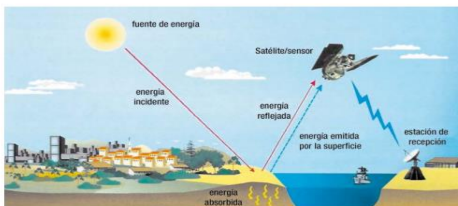
Ilustración 2. Elementos de la etapa de adquisición de datos por teledetección (o adquisición remota). Fuente Florenzano (2018)
