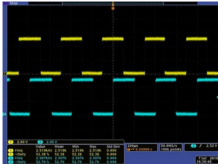
Figura 32 SALIDA EN CUADRATURA DEL ENCODER EFECTO HALL
