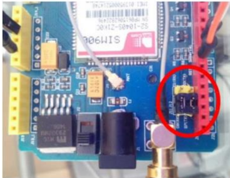
Figura 3. Ubicación del interruptor que selecciona pines (Tx, Rx). [6]
