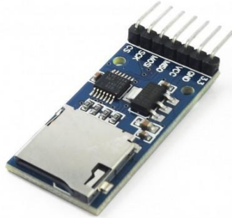
Figura 26. Módulo de memoria Micro SD. [8]
