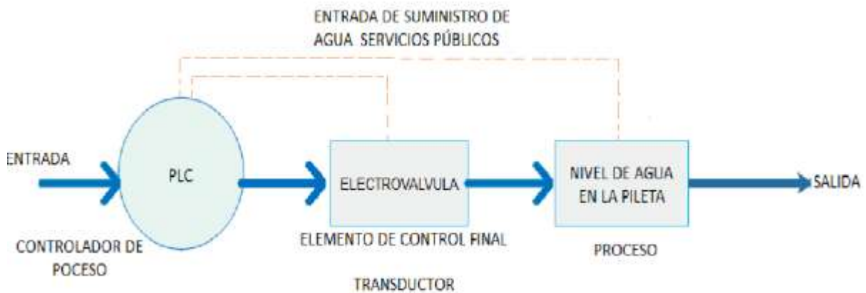
Figura 10. Sistema de Control de Nivel realizado en el software EDRAW. Fuente: Diagrama diseñado por el auto.
