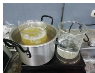
Figura 56. Aceite de coco en baño maría y solución de KOH con agua.
