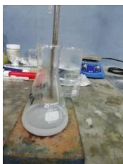
Figura 28. Aparición del color azul tenue el cual evidencia el inicio de la reacción de los peróxidos con la mezcla inicial.
