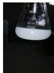
Figura 29. Final de la titulación, desaparición del color azul.
