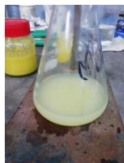
Figura 31. Valoración con tiosulfato de sodio, desaparición parcial de la coloración inicial y evidencia de una cloración azul-verdosa tenue
