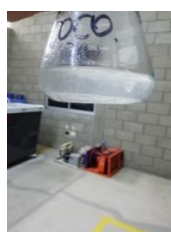
Figura 27. Desaparición del color debido a la reacción con un tiosulfato de sodio
