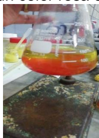
Figura 50. Valoración de la solución con tiosulfato de sodio.
