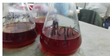
Figura 49. Adición del yoduro de potasio.
