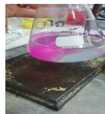
Figura 46. Aparición del color rosa evidencia de la presencia de yodo.
