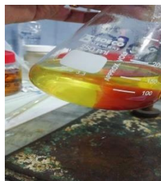
Figura 45. Valoración con tiosulfato, desaparición parcial de la coloración inicial.
