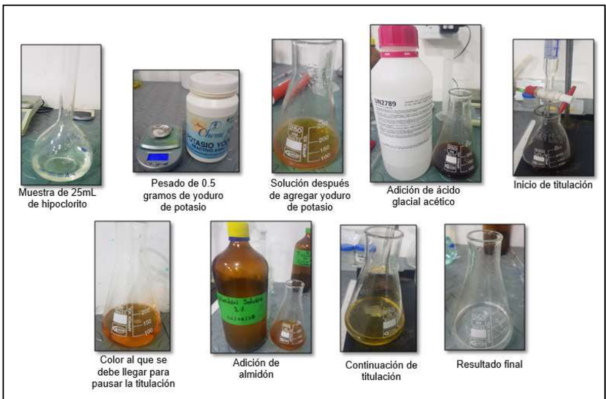
Figura 17. Procedimiento para la medición de concentración de hipoclorito de sodio por el método yodométrico
