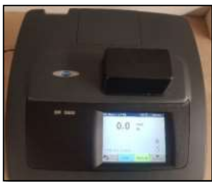
Figura 15. Espectrofotómetro utilizado para la medición de concentración de cloro
