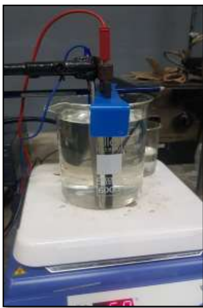
Figura 12. Montaje para la electrólisis de cloruro de sodio
