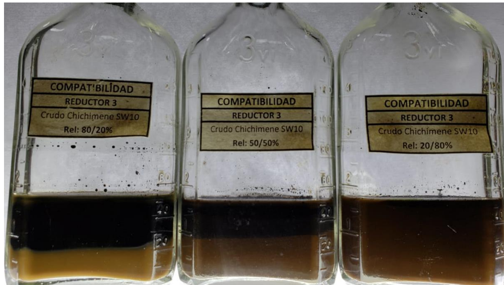
Figura 78. Prueba de botella para el crudo Chichimene SW10 con el reductor 3 (Autor., 2019)
