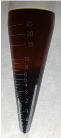
Figura 82. Prueba de ADT para el crudo Chichimene SW10 sin tratamiento (Autor., 2019)
