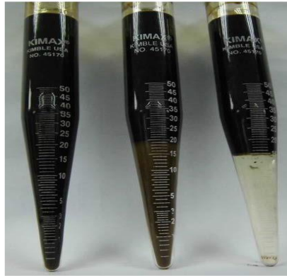
Figura 41. Tubos de centrifuga con las diferentes etapas de la prueba de BS&W (Montenegro., 2016)
