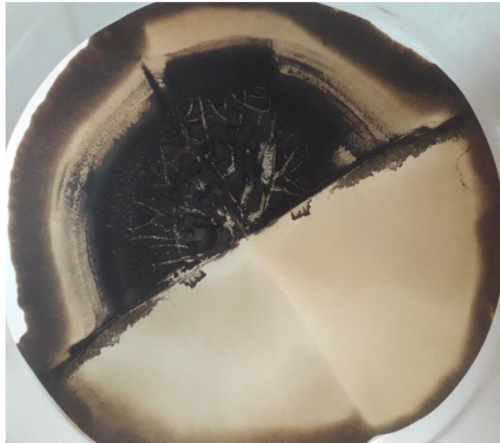
Figura 44. Asfaltenos precipitados por insolubilidad en un disolvente apolar, crudo Chichimene X (Autor., 2019)
