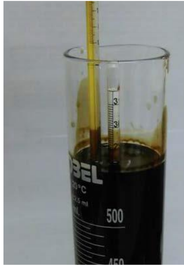
Figura 40. Montaje experimental para determinación de gravedad API por método del hidrometro (Montenegro., 2016)
