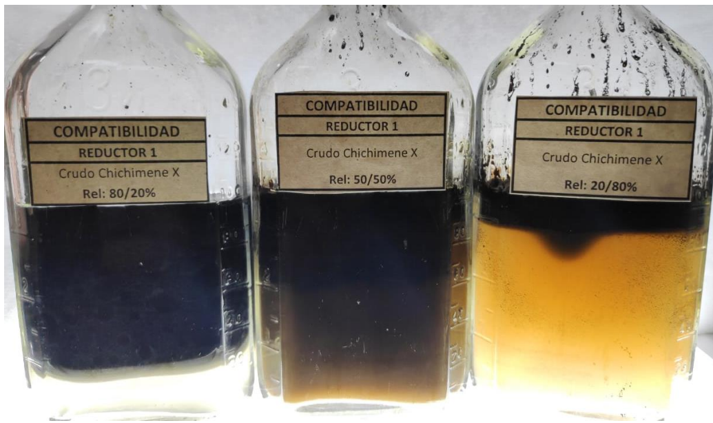
Figura 79. Prueba de botella para el crudo Chichimene X con el reductor 1 (Autor., 2019)
