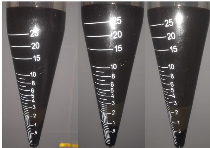
Figura 83. Prueba de ADT para el crudo Chichimene SW10 con los 3 reductores (Autor., 2019)
