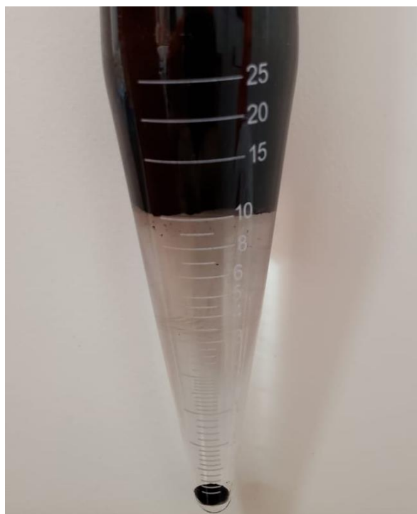
Figura 50. Prueba de BS&W para el crudo Chichimene SW10 (Autor., 2019)
