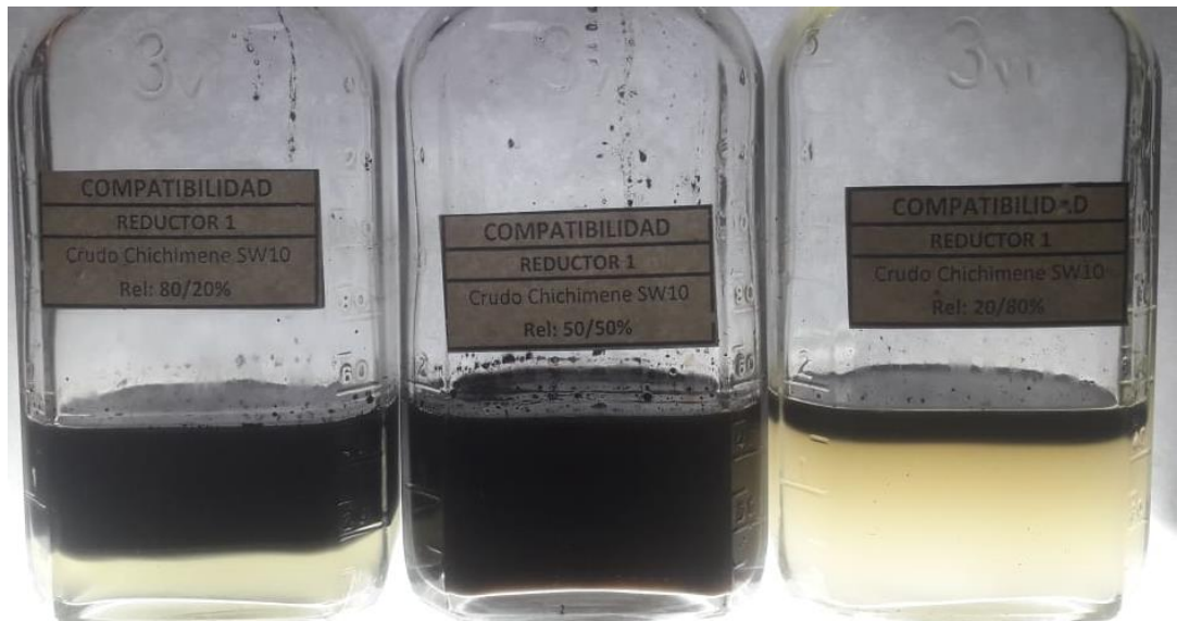
Figura 76. Prueba de botella para el crudo Chichimene SW10 con el reductor 1 (Autor., 2019)
