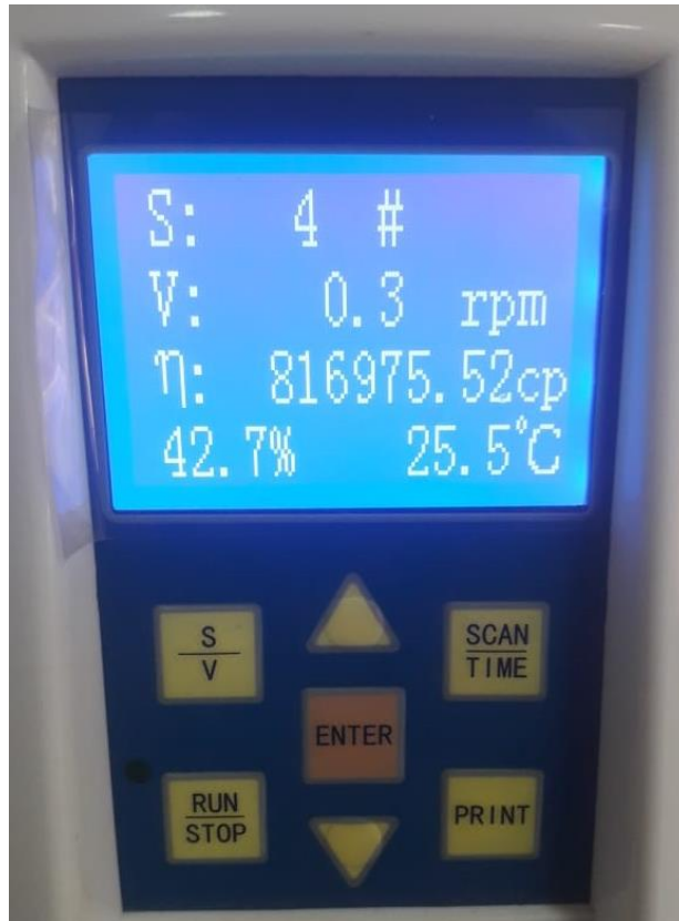
Figura 51. Valor de la viscosidad para el crudo Chichimene SW10 (Autor., 2019)
