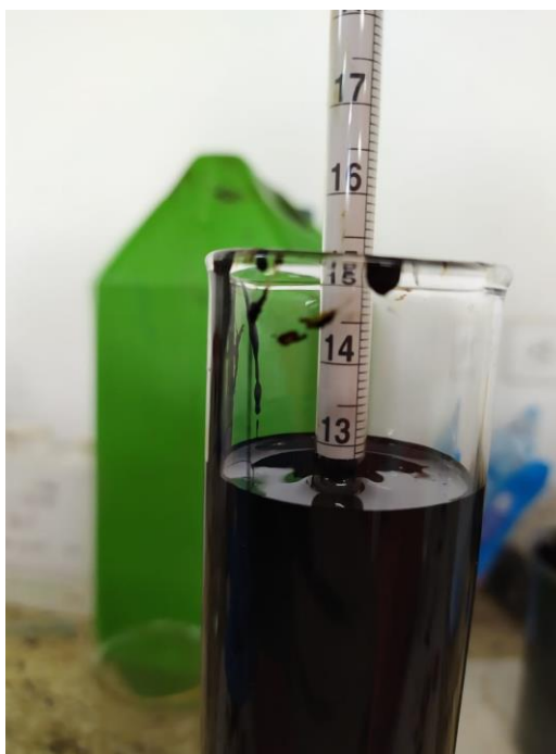
Figura 48. Prueba de °API para el crudo Chichimene SW10 (Autor., 2019)
