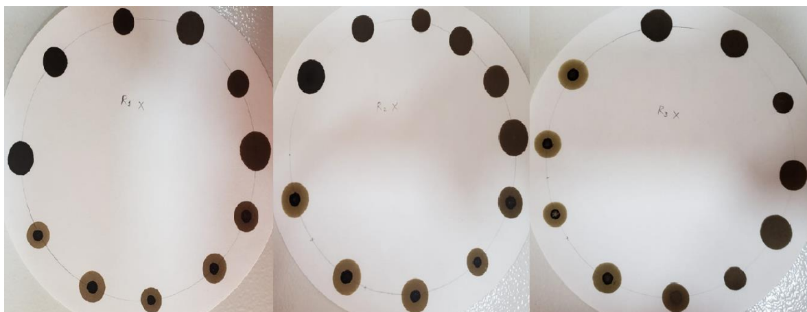
Figura 75. Prueba de oliensis para el crudo Chichimene X tratado con el reductor de viscosidad (Autor., 2019)
