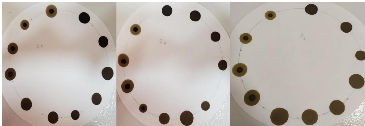
Figura 74. Prueba de oliensis para el crudo Chichimene SW10 tratado con el reductor de viscosidad (Autor., 2019)
