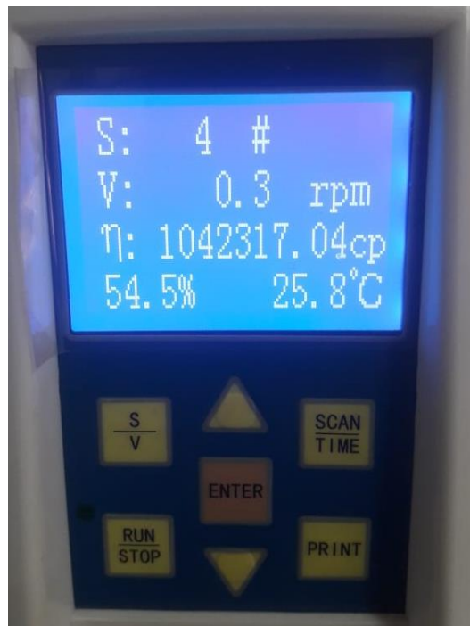
Figura 52. Valor de la viscosidad para el crudo Chichimene X (Autor., 2019)
