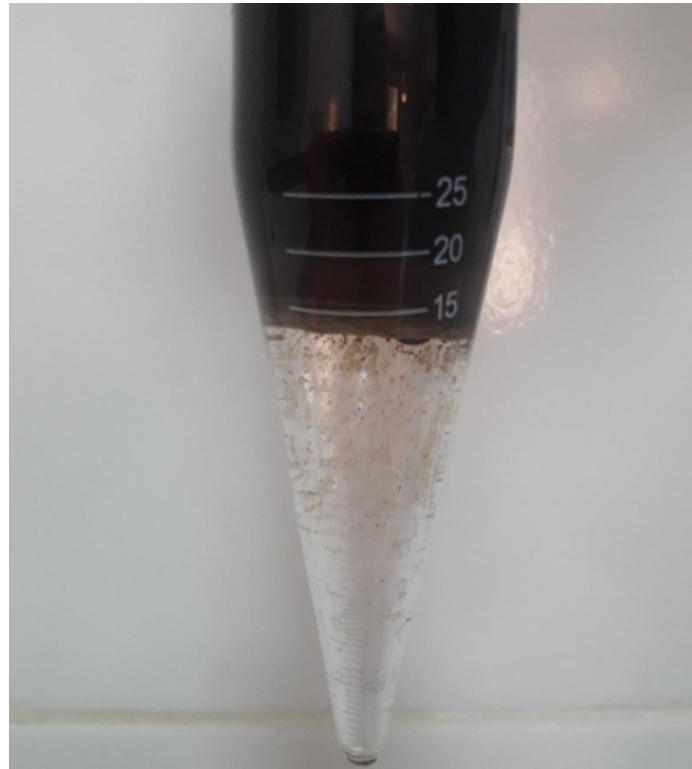
Figura 49. Prueba de BS&W para el crudo Chichimene X (Autor., 2019)
