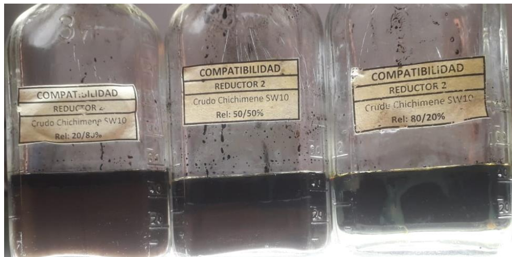
Figura 77. Prueba de botella para el crudo Chichimene SW10 con el reductor 2 (Autor., 2019)
