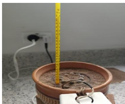
Figura 15: Montaje para el proceso de degradación plástica en horno abierto
