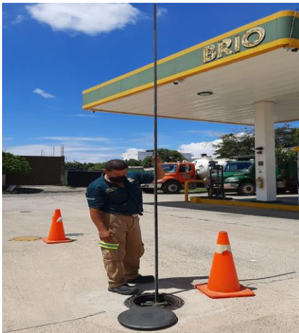
Ilustración 21. Medición del galonaje manual
