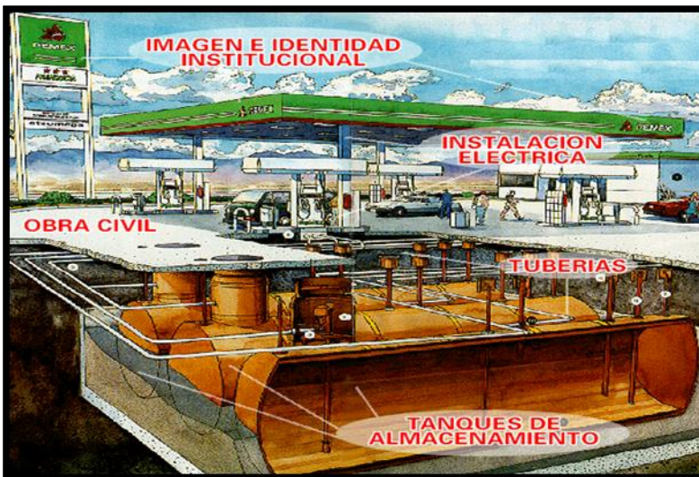
Ilustración 18. Estructura del almacenamiento
