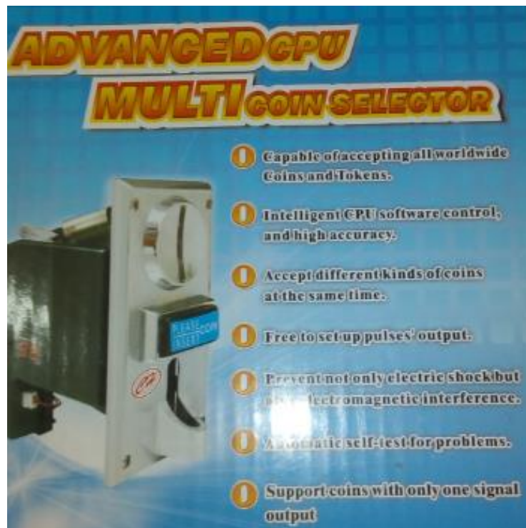
Figura 10. Selector de monedas Fuente: Imagen tomada por autor
