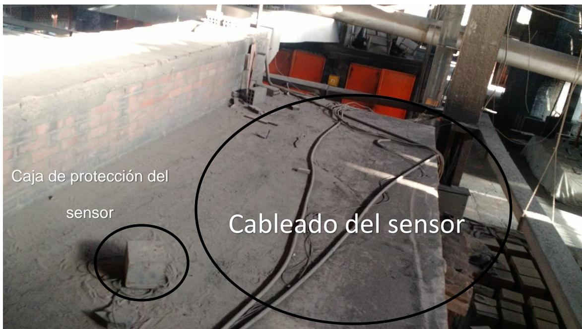
*Figura 24. Sensor instalado en el secadero 4 vista superior*
