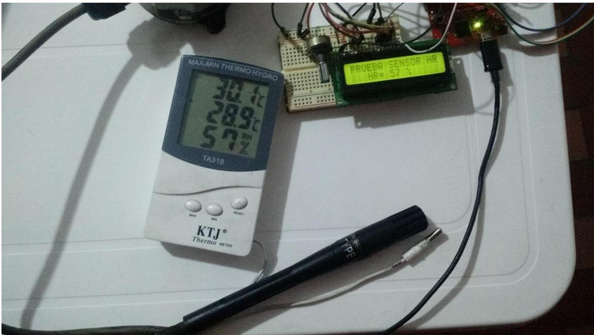
Figura 16. Prueba sensor a Humedad Relativa ambiente
