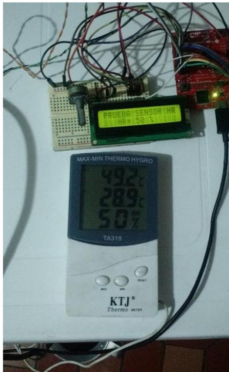
Figura 18. Prueba sensor de Humedad Relativa aumentando temperatura
