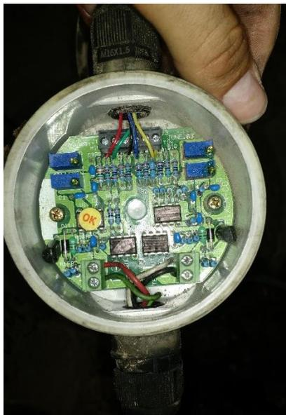
Figura 4. Vista interior del circuito del sensor Rixen TRH 303
