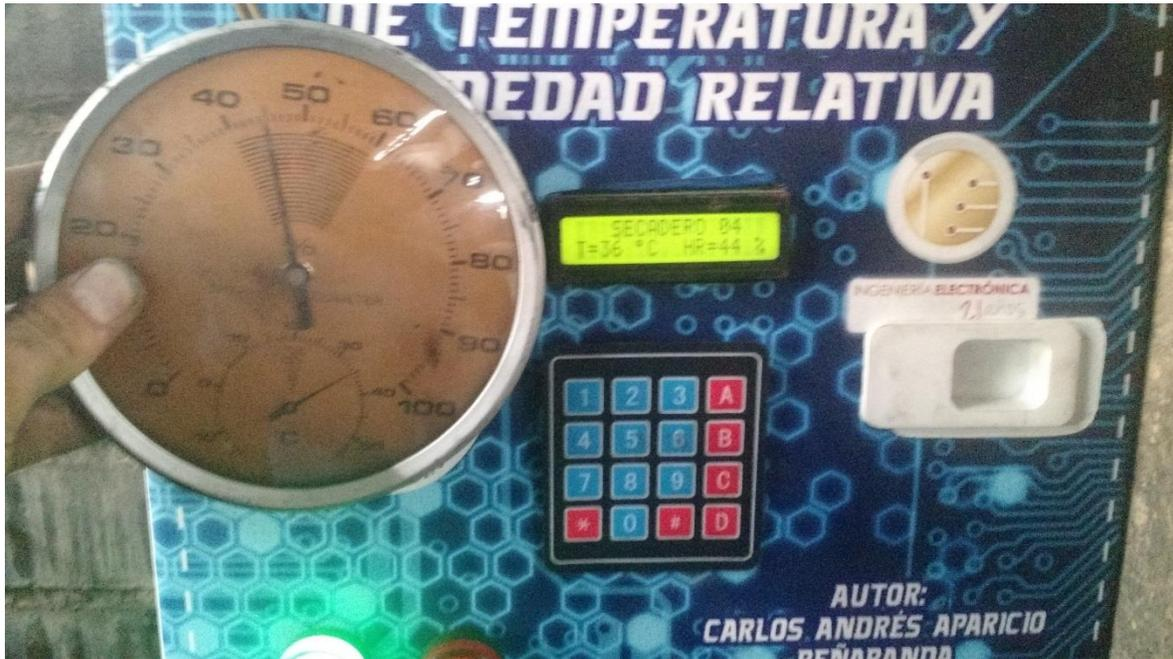
Figura 36. Instrumento Patrón Vs sistema de monitoreo
