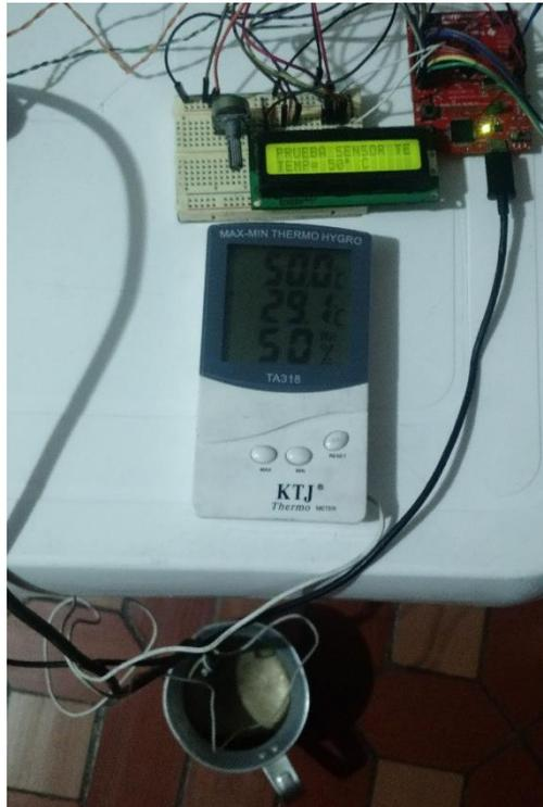
Figura 17. Prueba sensor de temperatura aumentando la temperatura
