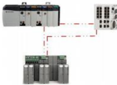
Figura 8. Topología anillo en el nivel de controlador.
