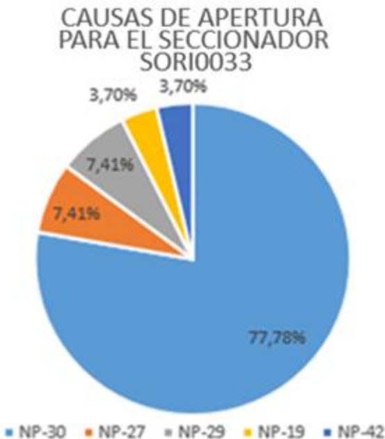
Ilustración 46 Distribución porcentual de las causas de aperturas en las protecciones del seccionador SORI0033.
