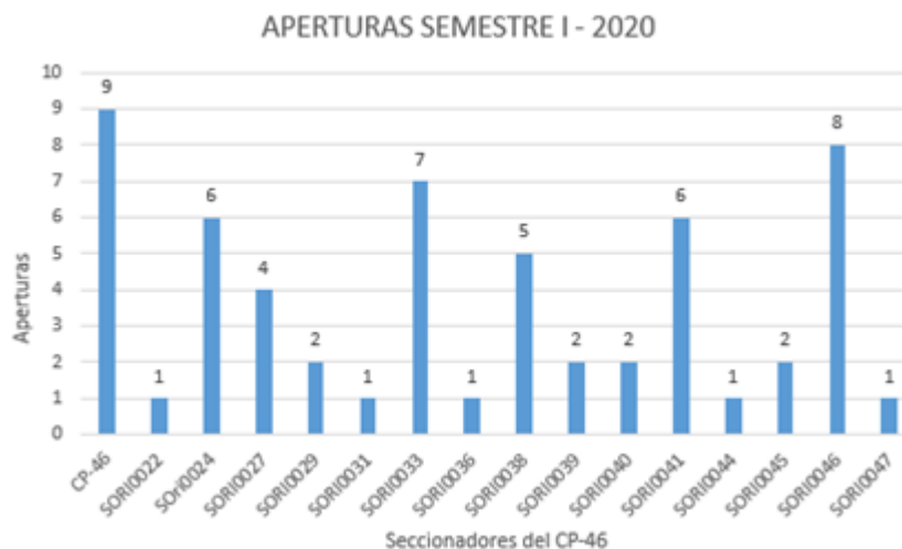
Ilustración 32 Aperturas por seccionadores del primer semestre del 2020 del circuito CP-46.
