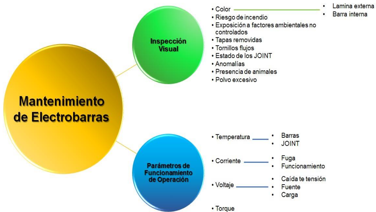
Figura 2.20. Parámetros a tener en cuenta en mantenimientos de electrobarras Fuente: Autor
