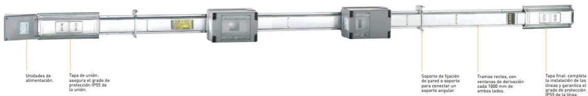
Figura 2.11 Esquema ilustrativo de electrobarras de baja potencia tipo minibarra
