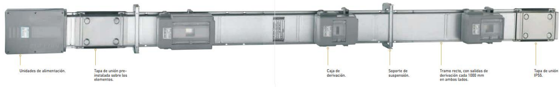
Figura 2.12.A. Esquema ilustrativo de electrobarras de media potencia Fuente: Manual técnico de sistemas de electrobarras Legrand Colombia
