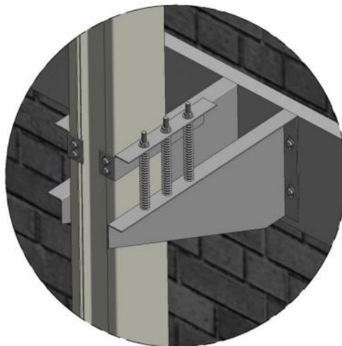
Figura 2.16. Esquema ilustrativo de soporte de electrobarra instalada verticalmente Fuente: RA8-019 de EPM
