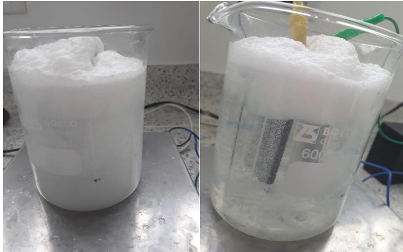
Imagen 5. Fotografía durante la electrocoagulación de la muestra de leche a 380 mA y 3V a 15 min (a) y (b) en reposo
