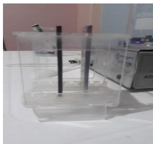
Imagen 1. Soporte para electrodos espaciado a 2 cm.
