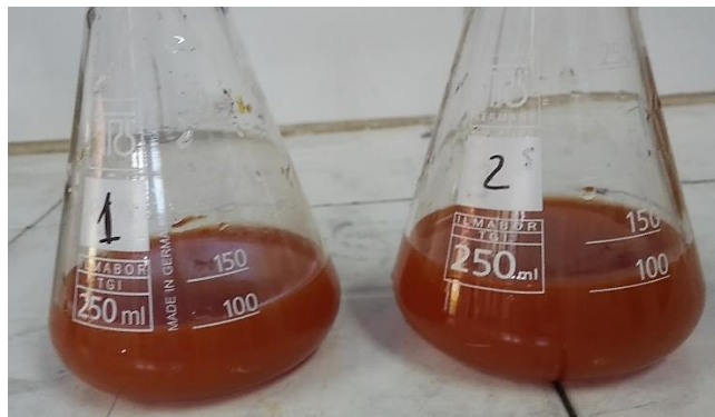
Imagen 12. Titulación con nitrato de plata 0,1N coloración roja punto final (fuente autor).
