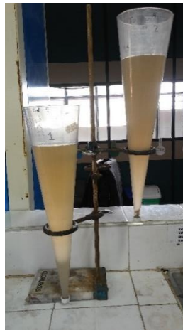
Imagen 7. Sedimentación en conos imhoff (fuente autor).
