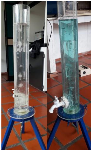
Imagen 22. Determinación experimental de tiempo de mezcla en el biorreactor por difusión de azul de metileno (fuente autor).
