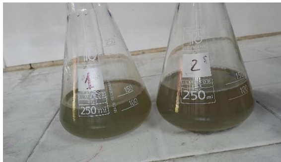
Imagen 11. Titulación con EDTA, indicador negro eriocromo (fuente autor).
