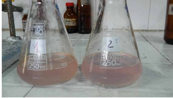
Imagen 10. Titulación con hidróxido de sodio, indicador fenolftaleína (fuente autor).
