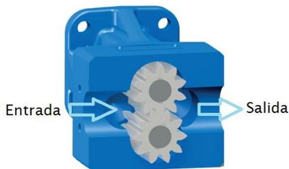
**Nota:** Tipos de bombas de desplazamiento positivo. Tomado de (Mur, 2019)
