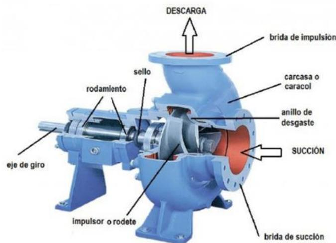
**Nota:** Bombas de Agua Centrífugas. Tomado de (CV, 2021)
