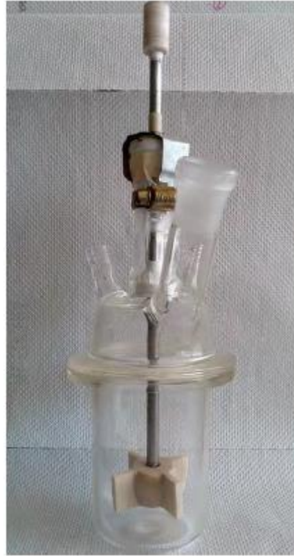
Ilustración 4 Reactor de pruebas en vidrio borosilicato, con agitador
