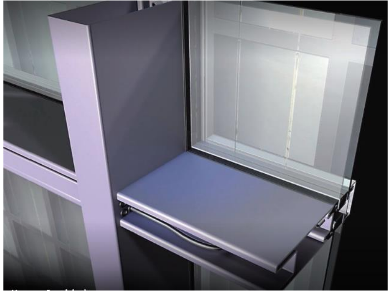
Ilustración 29 Modelo constructivo Vidrio FV
