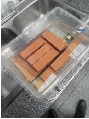
Figura 13. Prueba de absorción
