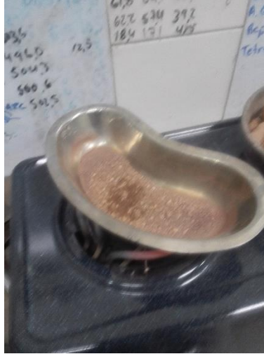
Figura 4. Perdida de agua en la arcilla
