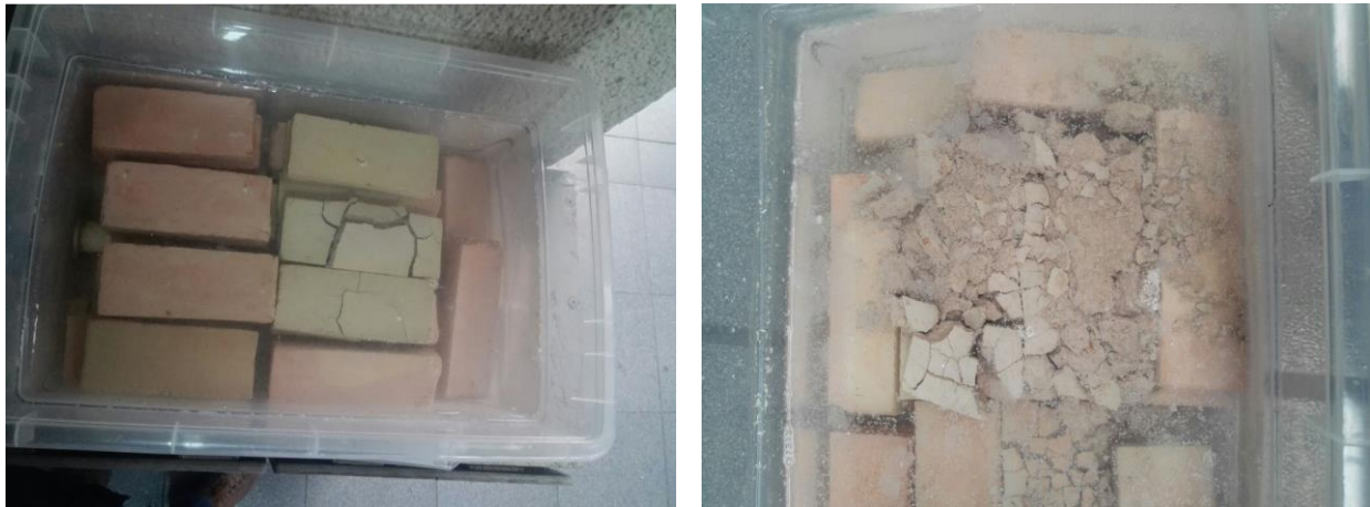
Figura 15. Ladrillos desleídos por el agua.
