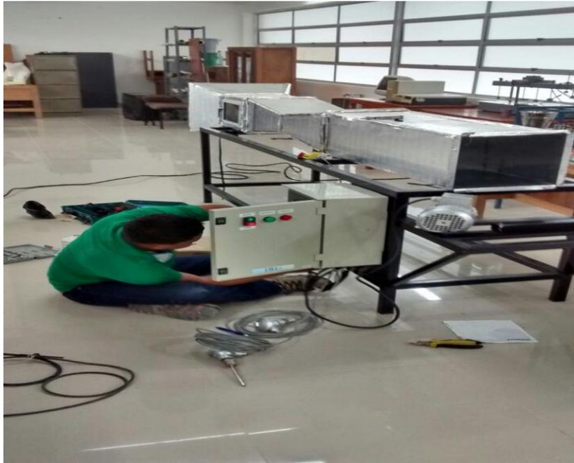
Ilustración 36. Montaje del equipo secador. Autor.
