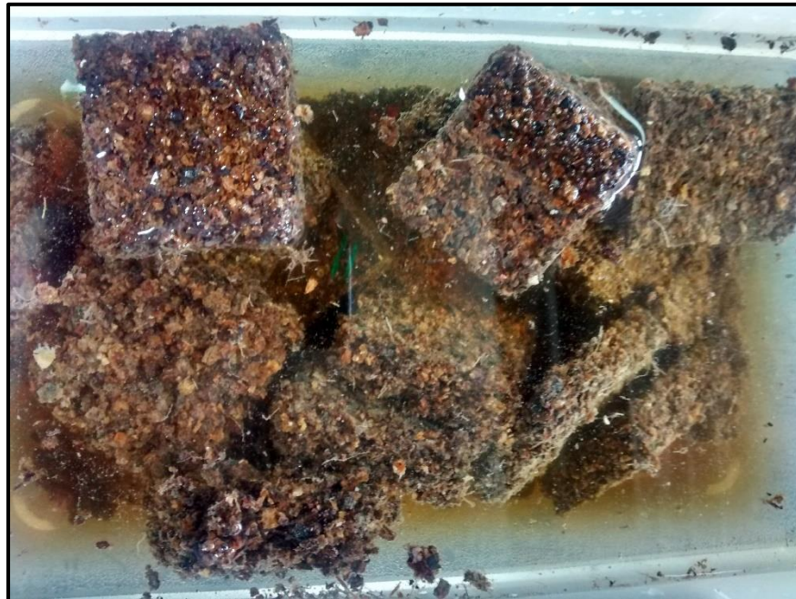
Gráfica 45. Muestras de tableros de CMC después de 2 horas en agua
